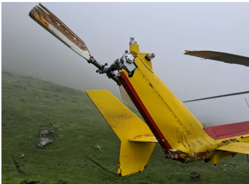
Figure 7 : endommagements de l'arrière de l'hélicoptère et du RAC
