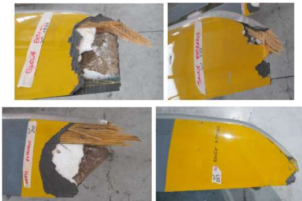
Figure 6 : extrémités endommagées des pales principales
