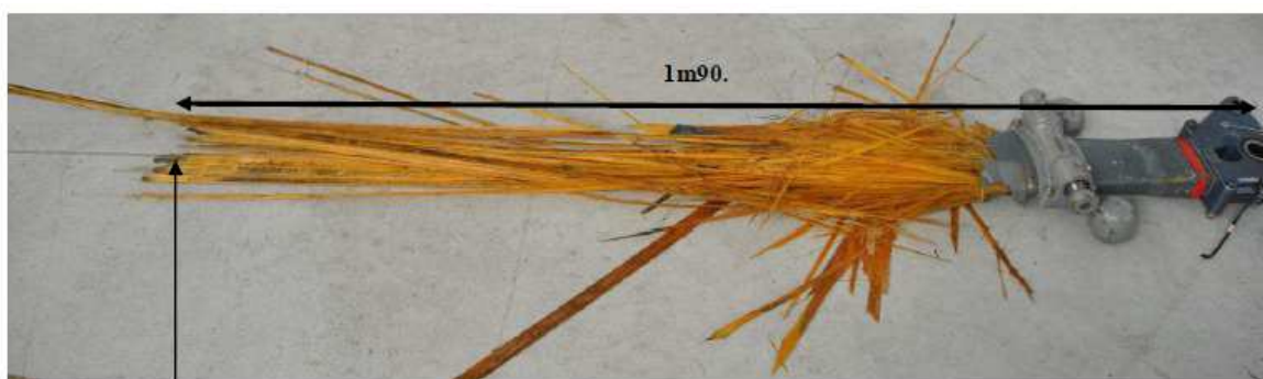
Rupture franche à 1m90.
