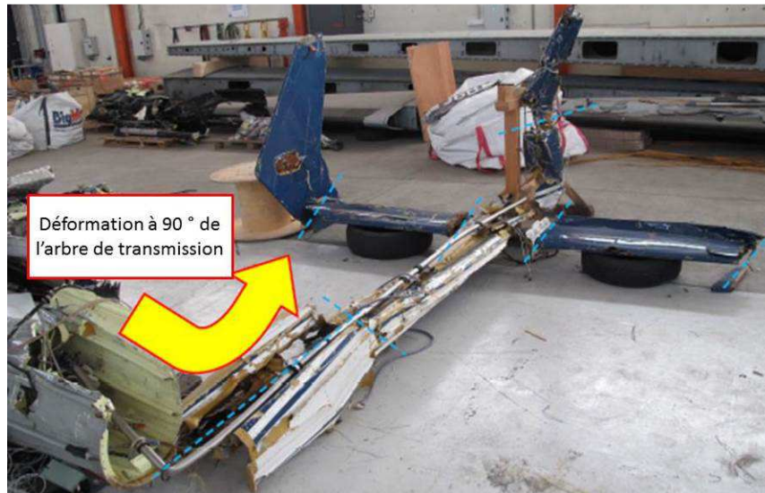
Vue de la déformation de l'arbre de transmission
